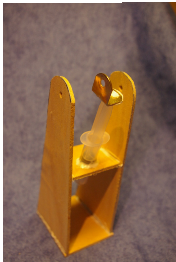
Foto 2.- DETALLE DE COLOCACIÓN DE ESCUADRA.
